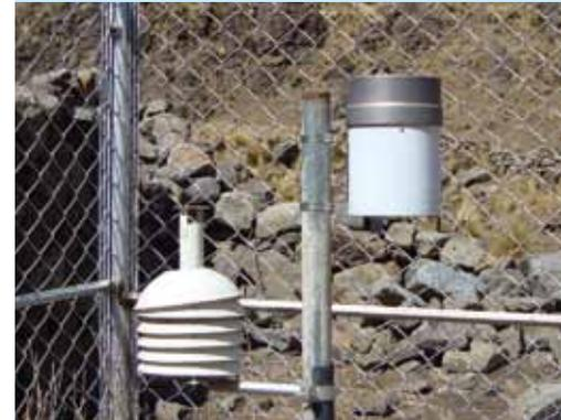
Termómetro y Pluviómetro
