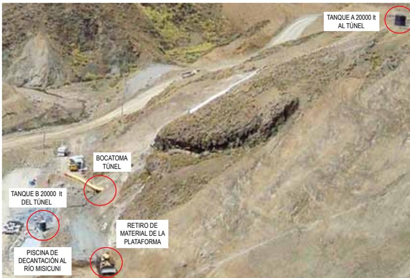
Esquema de tratamiento de aguas residuales provenientes del túnel de desvío
